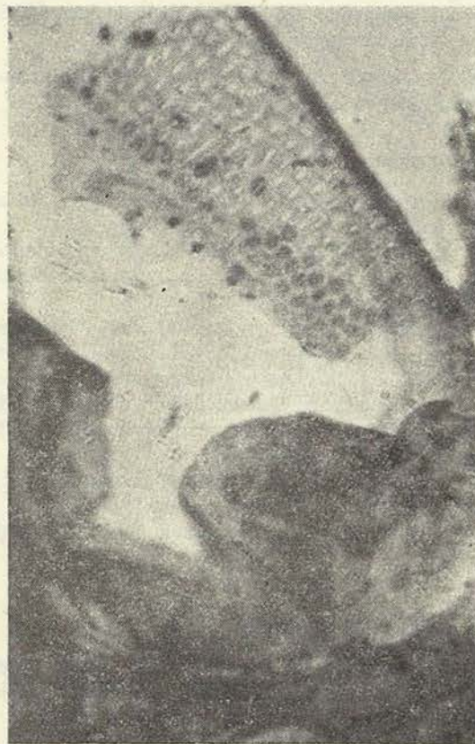
4. ábra. Calophyllum inophyllum L. Tangenciális hosszszelvény részlet. Mikroszkópos felvétel: 600X. A trachea falán jól látszanak az alternált helyzetű, kis méretű megnyúlt vermes gödörkék Faipari Kutatóintézet, Anatómiai Laboratórium
