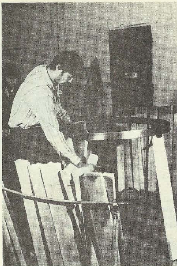
3. ábra. Figyelmes munkát igényel a hordópalást összeállítása
