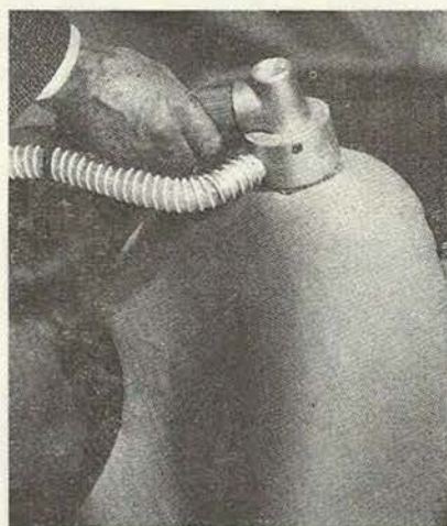
3. ábra. Az A. Kessel cég másik marószerszáma térgörbe felületek megmunkálására képes
