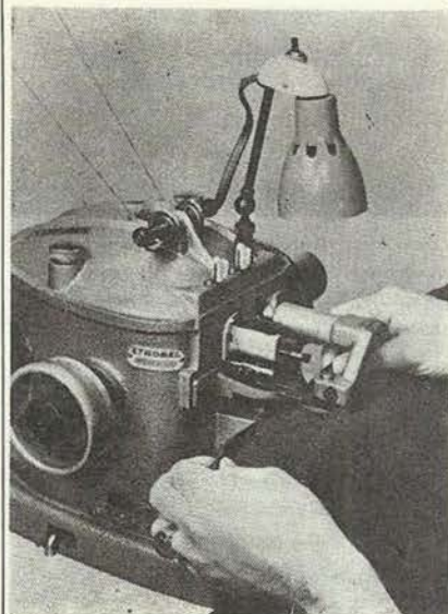
14. ábra. A Strobel cég bevonónyílás lezárására alkalmas célgépe
