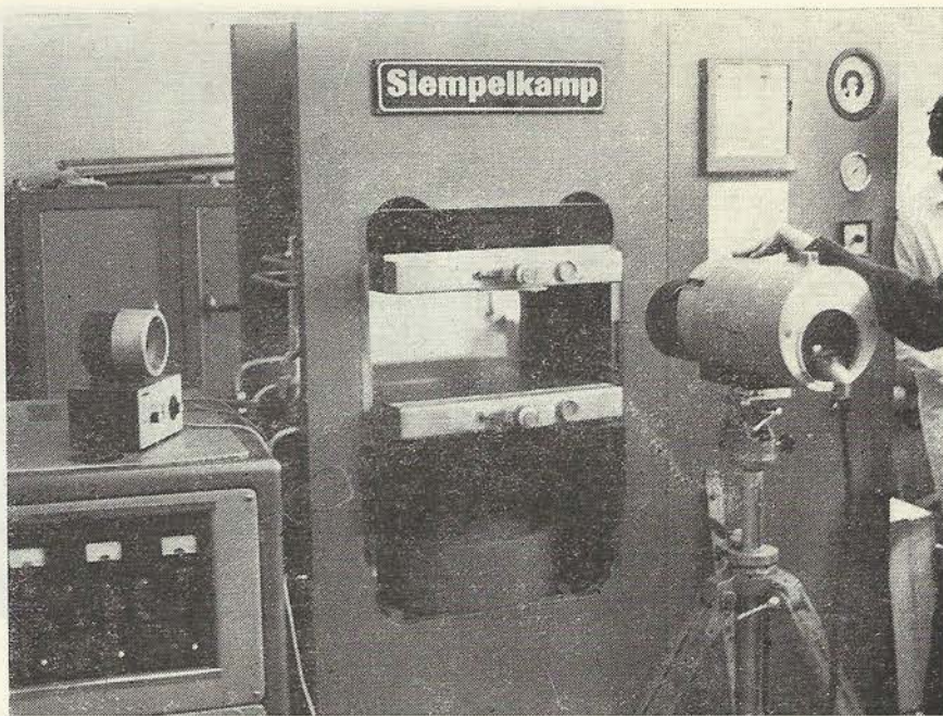
3. sz. ábra. Hidraulikus laboratóriumi prégép nagyfrekvenciás generátorral
