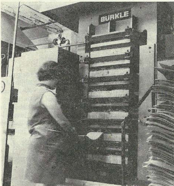
1. ábra: 6 etázsos hőprés, háttámla, idomszerszámokkal nyitott állapotban.
