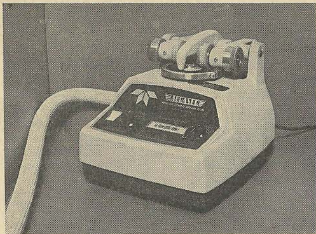
3. fénykép. TABER-készülék, kopásállóság meghatározásához
