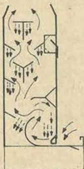
3. ábra. Összetett légtisztítású (vízöblítéssel és örvényáramlásos) szűrőberendezés axonometrikus rajza és a mosótorony metszete
