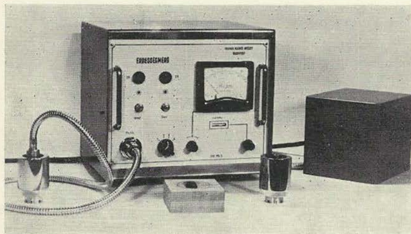
1. ábra. Pneumatikus kompenzációs rendszerű érdességmérő (Typ: PS—5)
