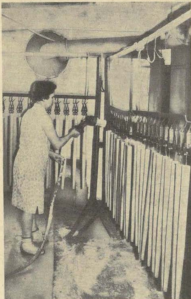
1. ábra. Asztallábak elektrosztatikus lakkszórása
