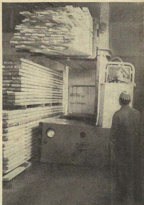
3. ábra. Fűrészáru egységakományok máglyázása oldalvillás targoncával
