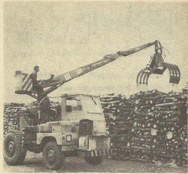
2. ábra. Dömpér alvázra szerelt HIAB daru munka közben
