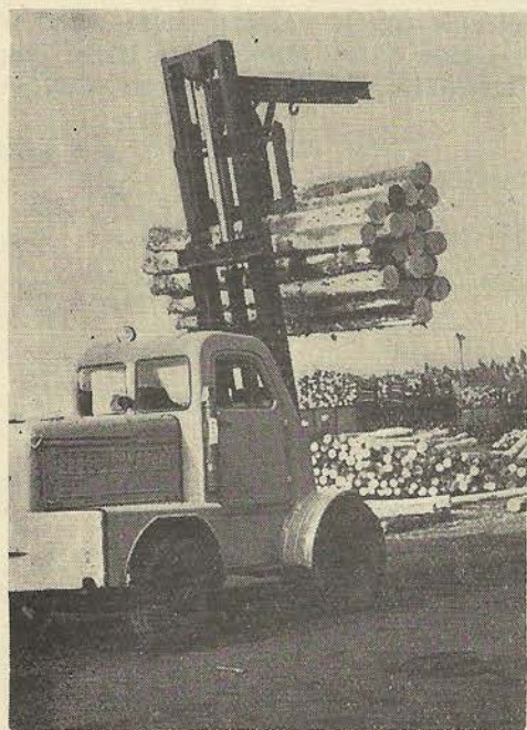
7. ábra. Kiosztályozott, kéregzett bányafa szállítása szovjet targoncával
