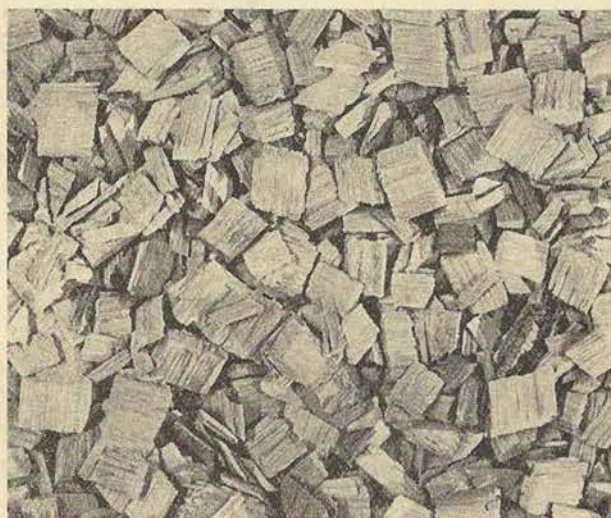
7. ábra. Tölgyfaapríték. Rostátvágsi szög \psi = 60^\circ
