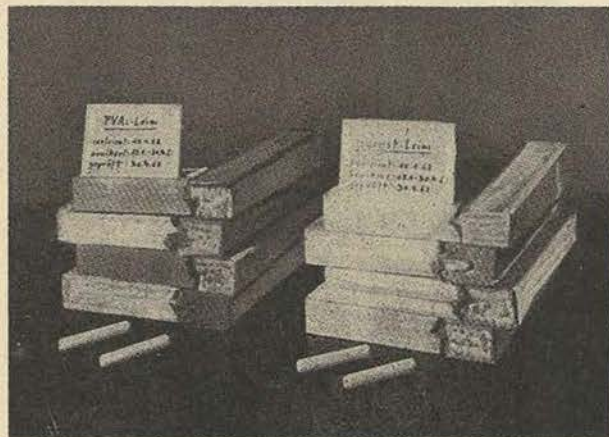
5. ábra. Normál klíma mellett tárolt ablakszárnykeretek állapota a szilárdsági vizsgálat után. Balra: PVAC-ragasztó, jobbra: karbamid-formaldehid ragasztó
