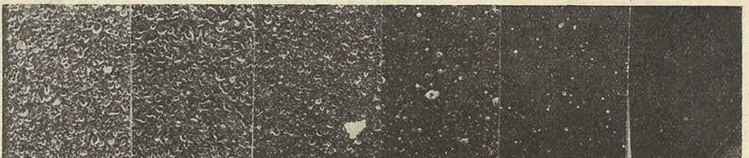
3. ábra. Karbamid-típusú (50%-os szárazanyagtartalmú) kötőanyag porlasztási képe a porlasztási kúpban mérve 2 att. és 7 att. porlasztónyomás mellett (15× nagyításban)
