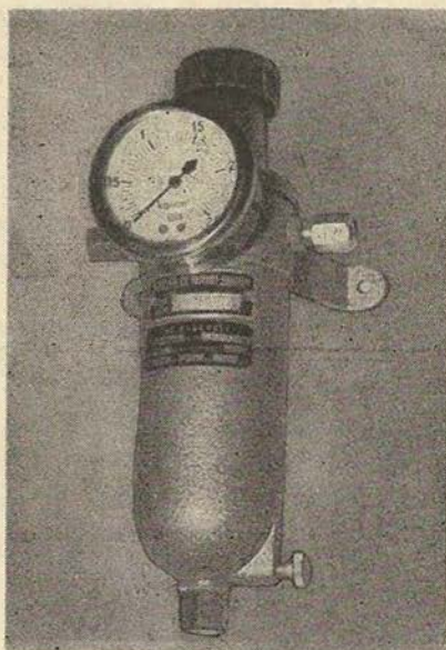
6. ábra. Pneumatikus tápegység a levegőnyomás beállítására és szűrésére
