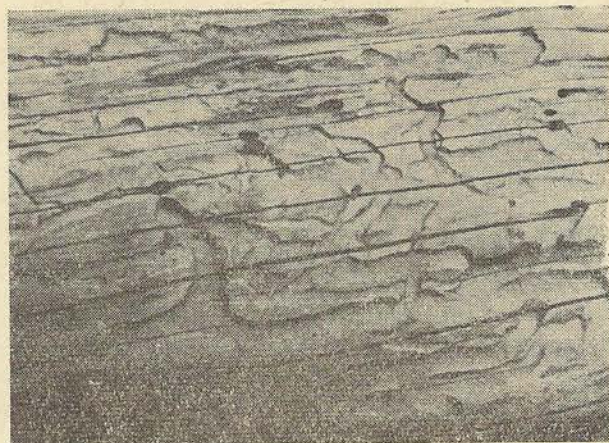
17. ábra. Fatestbe hatoló álcamenetek. Változó háncscincér Callidium sp. kártétele. (Foto: Faipari Kut. Int.)
