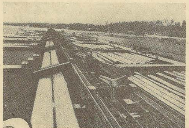
2. ábra. Rönkosztályozó lánctranszportör automatikus rönkleterhelő szerkezettel. (Tornborg—Lundberg)
