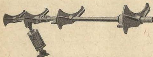
4. ábra. Hidraulikus rönkadagoló „félhold”-ak (W. Gillet, Franciaország)
