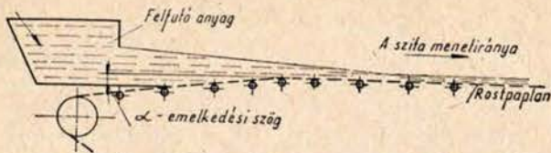
7. ábra. A szítaszakasz elejének sematikus ábrázolása
