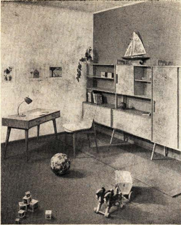
1. ábra. Gyermek-szobabútor az ún. „szerelési elv” alapján kialakítva, gőzölt bükk, színes műanyagfólia burkolattal
