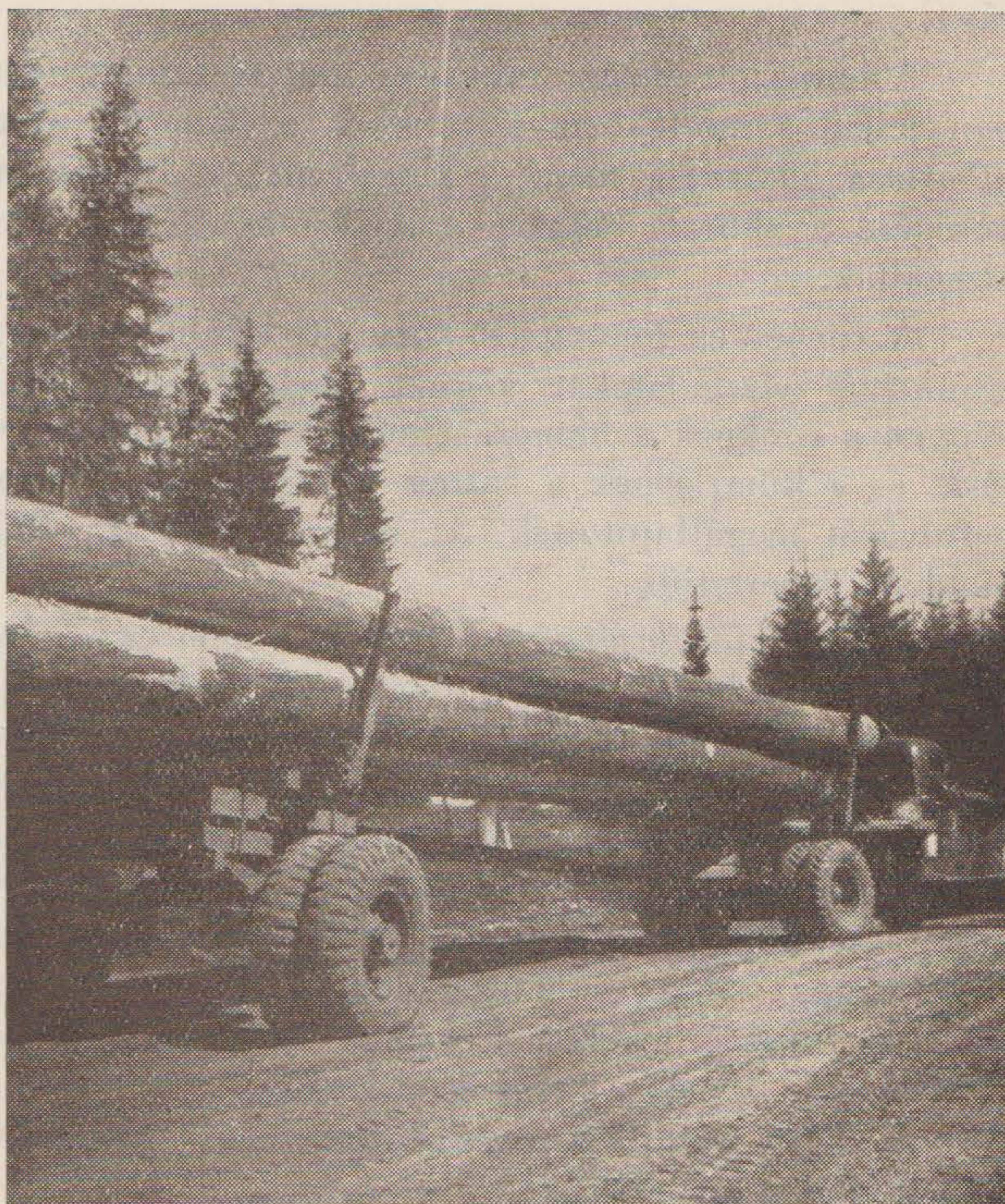
A 3, V, C” típusú önrakódó teherkocsi rönköket szállít a vasúti állomásra
