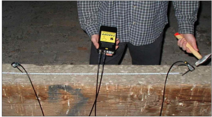
Kötőgerenda roncsolásmentes faanyagvizsgálata FAKOPP műszerrel (Divós F.)
