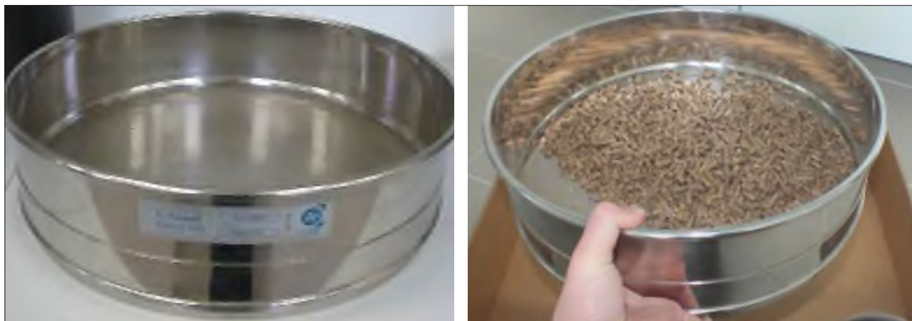
2. ábra Szabványos szita és a szitálás művelete a finomhányad meghatározásához
