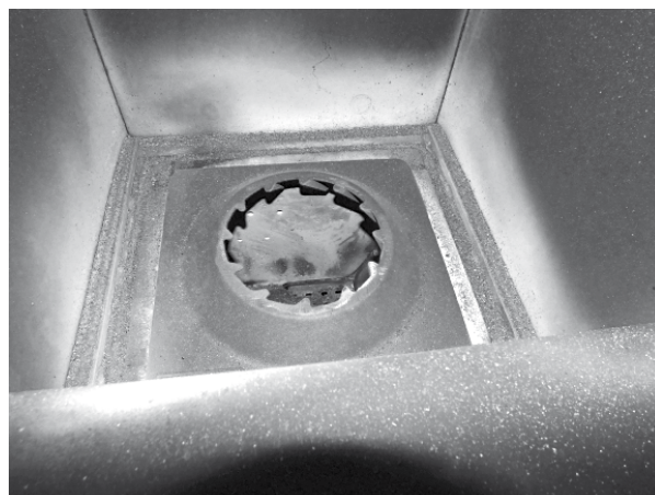
3. ábra Apríték és pellet égetésére alkalmas égőfej, égéstér kis teljesítményű kazán esetén (NymE, NRRC - Energetikai Laboratórium; Buderus LOGANO SH 25 apríték és pellet tüzelésű kazán)
