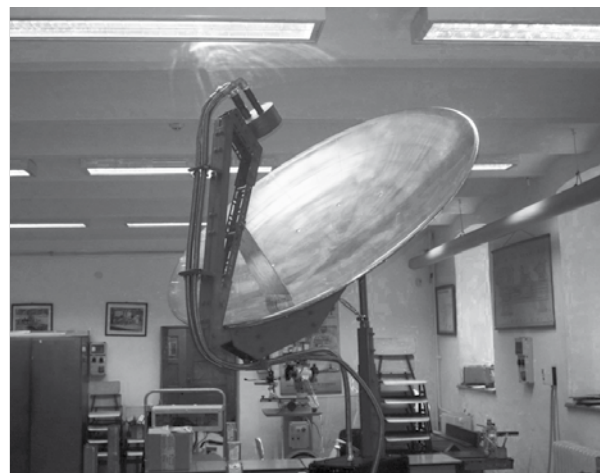
4. ábra A parabolatányér és a kollektor kialakítása (Forrás: saját kép) Figure 4 The developed solar thermal collector dish
