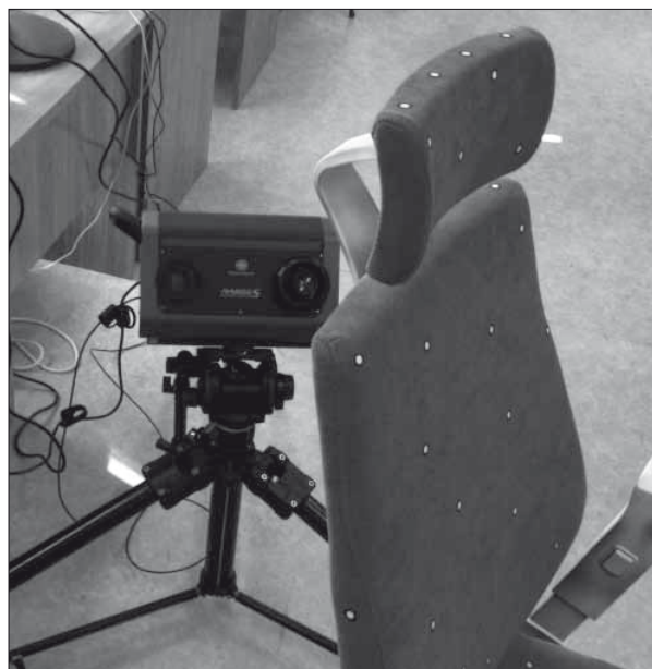
5. kép 3D szkennelés Konica Minolta Range 5 szkennelőkkel
