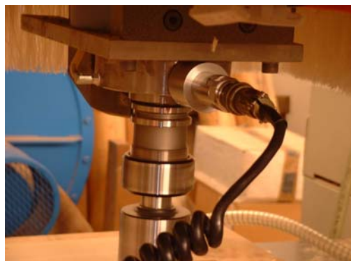
4. ábra – A gyorsulásérzékelő rögzítése a szerszámtengely csapágyazásán
