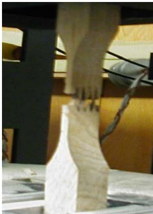
2. ábra – A rostirányú húzószilárdság vizsgálata
