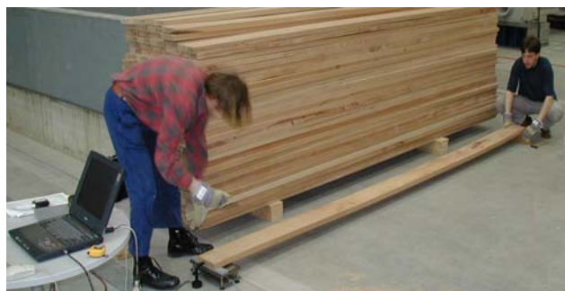
1. ábra – Bükk lamellák osztályozása a Graz-i Műszaki Egyetemen.
