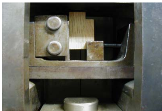
6. ábra – A nyírószilárdság vizsgálata
