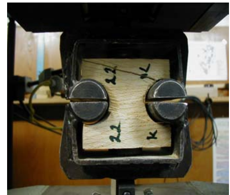
4. ábra – A rostra merőleges húzószilárdság vizsgálata
