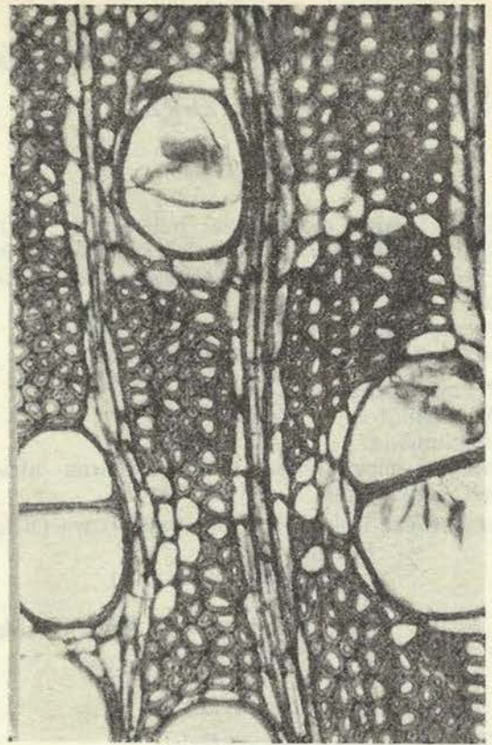
3. ábra Essia-Combretodendron africanum (Welw.) Exell. Keresztmetszet Mikroszkópos felvétel: 120x FKI, Anatómiai Laboratórium
