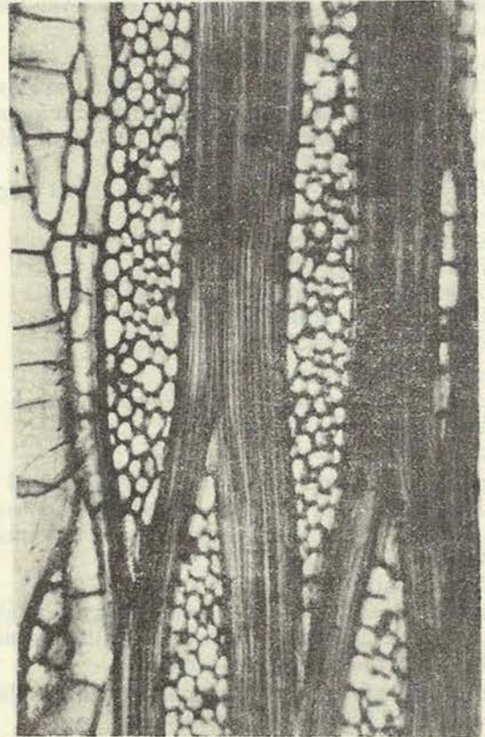
5. ábra Essia-Combretodendron africanum (Welw.) Exell. Tangenciális hosszmetset Mikroszkópos felvétel: 120x Edény, hosszparenchyma egy és több széles heterogén bélsugarak, rostok FKI, Anatómiai Laboratórium
