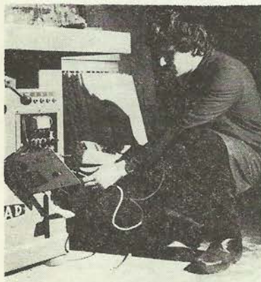
1. Érintésvédelmi (nullázási hurokellenállás) mérés
