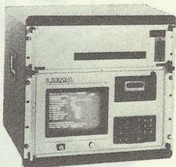
4. ábra. LUMA 140. Processzoros helyzetvezérlő 60 szerszámtengelyig, automatikus hitelesítéssel, párbeszédés programszerkesztés, nagy kapacitású programtár, kazettás adatrögzítés
