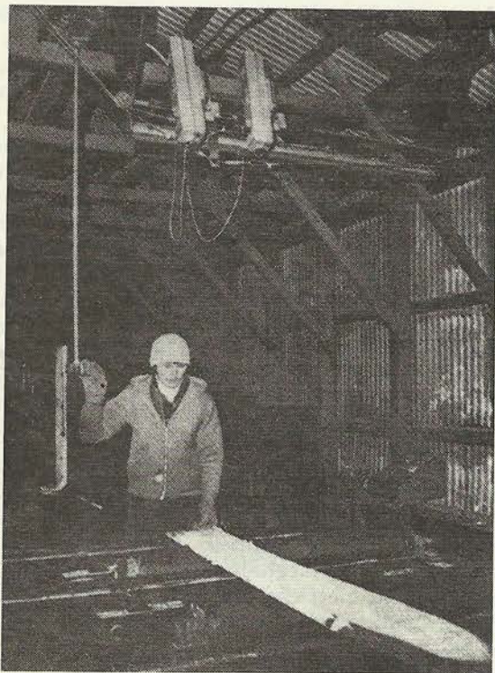
20. ábra. Vonál-vetítők alkalmazása kettős szélező körfűrészhez egy keménylombos anyagot feldolgozó (Quality Hardwoods Inc., USA) fűrészüzemben (11)
