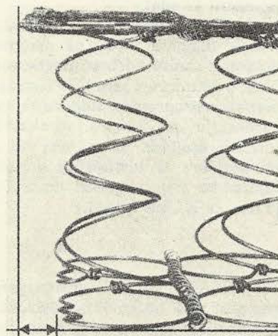
10. ábra. A Hahn cég hullámalakban meghajlított ún. „golyvás” rugóeleme a felső élnek 20 mm-es kiállást biztosít
