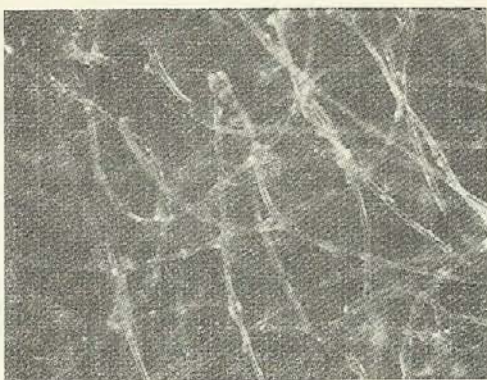
6. ábra. Laza nemszött kelme: a mikrofelvételen jól látható, hogy a szálakat a kötőanyag találkozási pontjaikon kapcsolja össze
