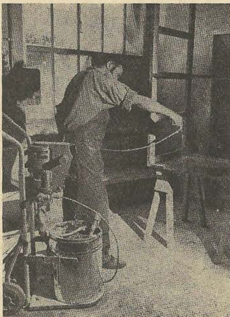
4. kép. Variant C—3020 F tip. szóró berendezés gumikerekes állványra szerelve, üzem közben
