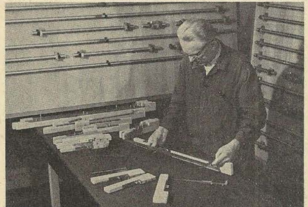
6. ábra. Fix kaliberek szerelése
