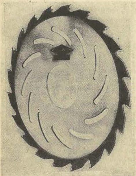
8. ábra. Rugalmas középtartományú körfűrészlap (R. Felde, NSZK)
