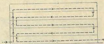
8. ábra. Többszintű épületben megoldott faipari üzem megtört vonalú munkafolyamatának ábrázolása (met-szet-vázlat)
