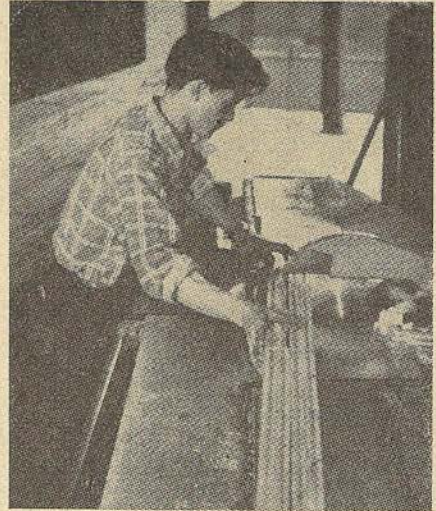
Az elvétel oldaláról fényképezett keresztfűrész. Figyeljük meg a szállítószalagot a jobb sarok alsó részében
