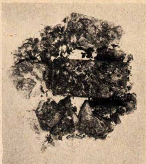
10. kép. Karbamid alapú forgácslap pusztulása 4 hónapi Merulius fertőzés hatására
