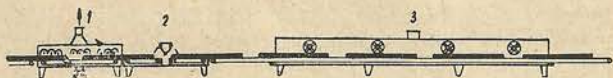
3. kép. Lakkozás és szárítás futószalagon: 1 = infravörös csatorna, 2 = lakkontógép, 3 = keringő levegővel üzemeltetett szárítócsatorna (műhelyrajz)
