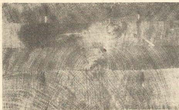
12. ábra. Négyrétegű ragasztott tölgytálpfa próbatest 26 \times 16 cm keresztmetszeti mérettel 18 órán át történt vízbenfőzés után. A ragasztási felületek teljesen épek maradtak
