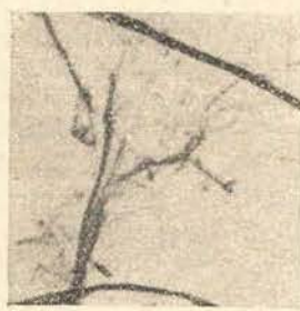
9. ábra. Rostositott defibrátorpép, amely különleges feltételek között jött létre, 80-szoros nagyítás
