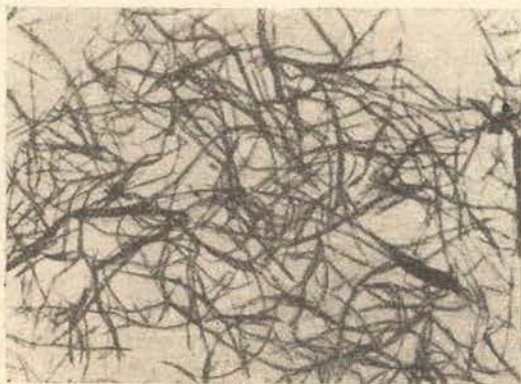
5. ábra. Laboratóriumi defibrátorból származó pép 20-szoros nagyítás
