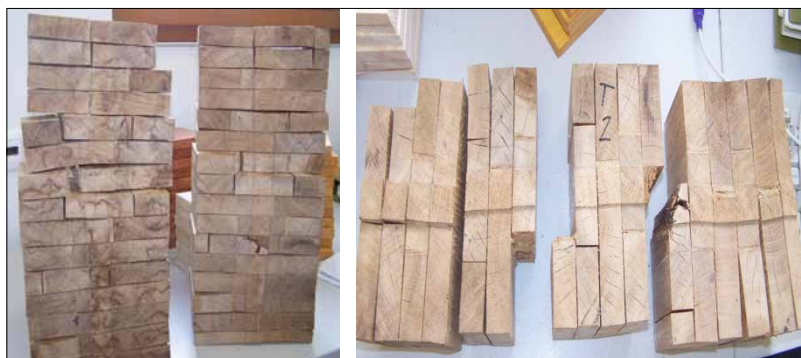
3. ábra Delaminálódott tölgy RR minták
