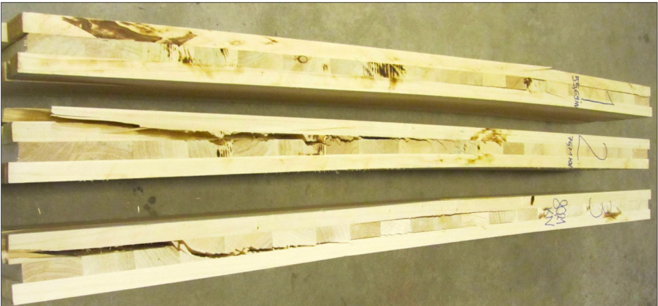
6. ábra A vizsgált próbatetek tönkremeneteli formái
