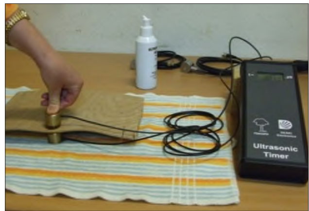
1. ábra A rugalmassági modulus mérése sugárirányban Figure 1 Measuring the MOE in the radial direction
