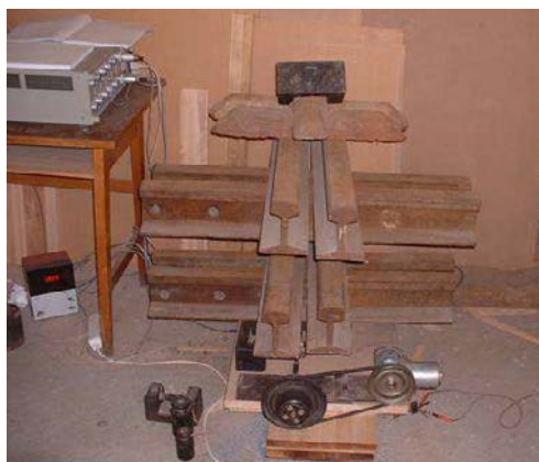
3. ábra – Munkadarab elmozdítás raszterasztalon, súlyterhelésnél
