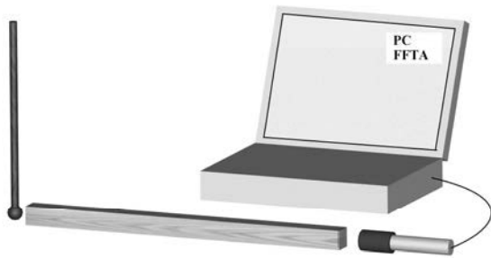
2. ábra – A próbatest longitudinális frekvenciájának meghatározása
