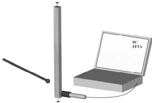
4. ábra – A próbatest torziós frekvenciájának meghatározása
