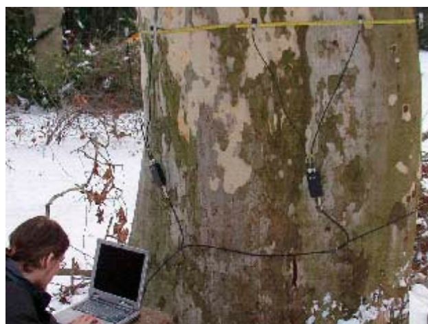
5. ábra: Akusztikus tomográf 8 csatornás elrendezésben platánfa vizsgálata közben
