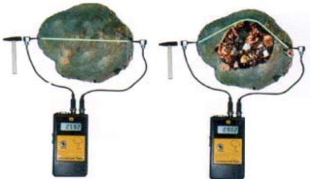
2. ábra: A hang terjedési ideje egészséges és korhadt fában, rostirányra mérőlegesen. A hang egy lehetséges útját a szürke vonal jelzi
