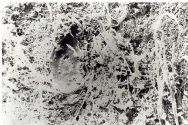
2. ábra – Üvegszál erősítésű gipszkötésű rostlemez. Nagyítás 70x (Takáts 1995)
