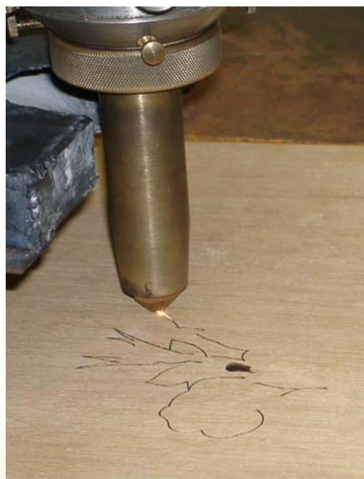
3. ábra – Bonyolult alakzatok vágása lézerral
