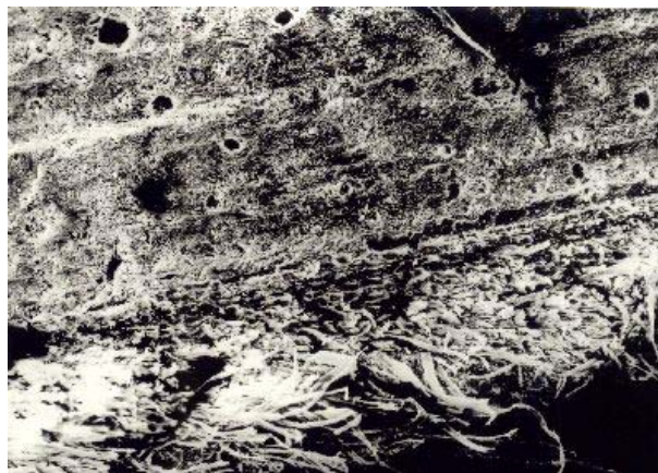
3. ábra – Gipszkarton lap élfelülete. Nagyítás: 70x (Takáts 1993)
