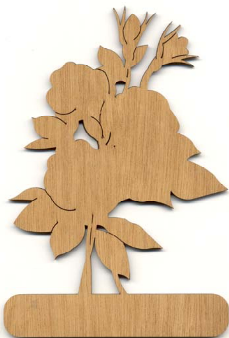
3. ábra – Bonyolult alakzatok vágása lézerral
