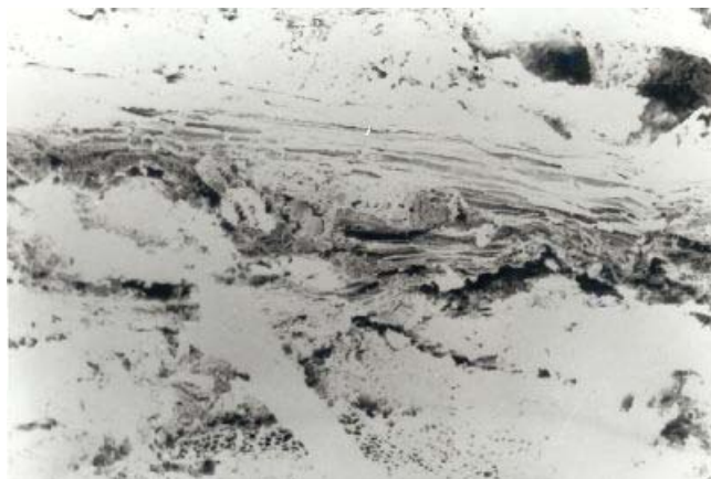
5. ábra – Bison gipszkötésű forgácslap. Nagyítás: 70x (Takáts 1995)
