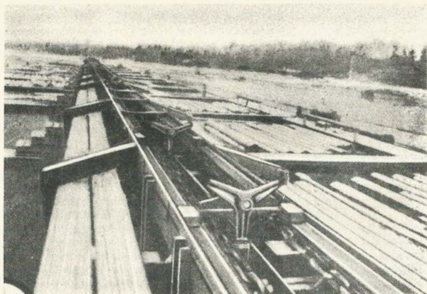
14. ábra. Rönk osztályozó lánctranszportőr billenőtagos leterhelő szerkezettel. (Tornborg Lundberg)
